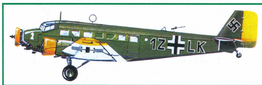
Junkers Ju 52/3 : avion de transport et remorquage de planeurs Autonomie 1280 km, 265 km/h
