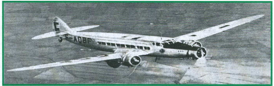
Dewoitine D-338 : avion de transport civil (1936) dérivé du D-333 ; 31 exemplaires construits pour Air France, 22 passagers Autonomie 2060 km, 260 km/h
